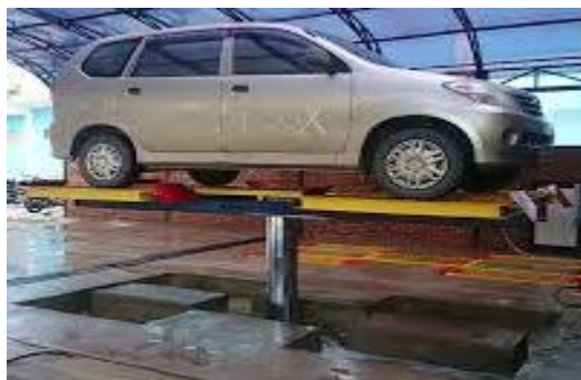
Gambar 2.1 Mesin hidrolik pengangkat mobil
