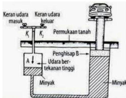
Gambar 2.2. Sketsa mesin hidrolik pengangkat mobil
