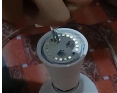
Gambar 2.3 Pengecekan lampu yang rusak
