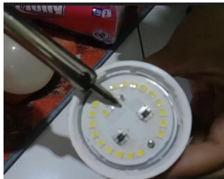
Gambar 2.4 Proses perbaikan lampu
