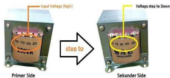
Gambar 5. Trafo Step Up Dan Step Down
