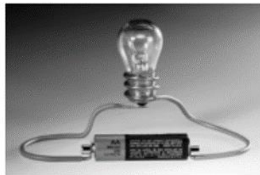
Gambar 1. Rangkaian Listrik Sederhana (Sumber: Giancoli, 2014: 504)
