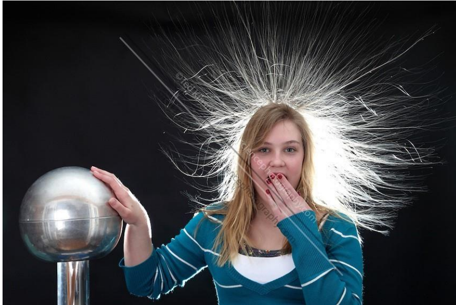
Gambar 7. Generator elektrostatis Van De Graaff digunakan sebagai akselerator partikel bermuatan. (Source: tedkinsman.com)
