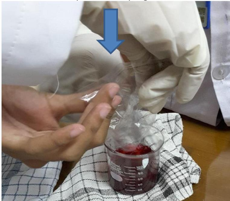
**Gambar 5.** Tambahkan zat warna ke dalam larutan pengikat
