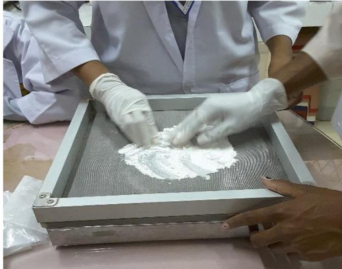
**Gambar 2.** Masing-masing bahan diayak dengan Ayakan no. 40
