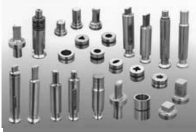
**Gambar 4.** Bentuk-bentuk *punch* dan *dies*
