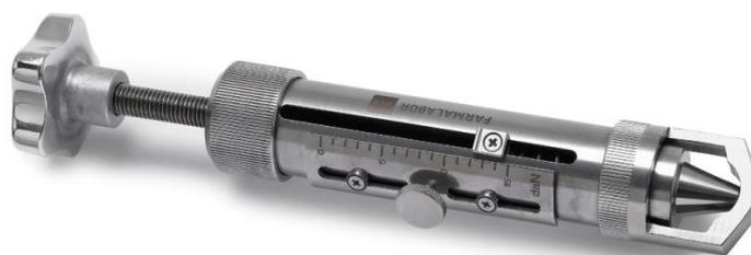
**Gambar 11.** Alat uji ukur kekerasan tablet manual.
