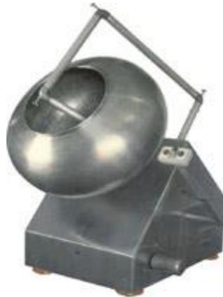
**Gambar 2.** Mesin penyalut tablet
