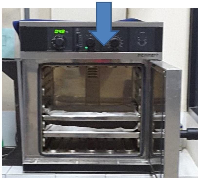
**Gambar 11.** Masukkan wadah oven, untuk mengeringkan granulat
