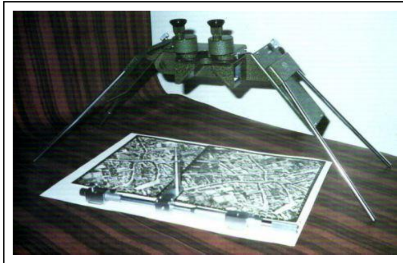
Gambar 2. Stereoskop cermin untuk mengamati dua foto udara yang bertampalan
