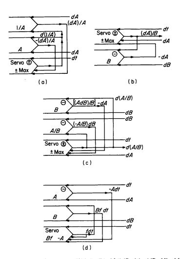
Fig. 8.23. Generation of (a) d(1/A), (b) (dA)/B, (c) A/B, (d) A/B
