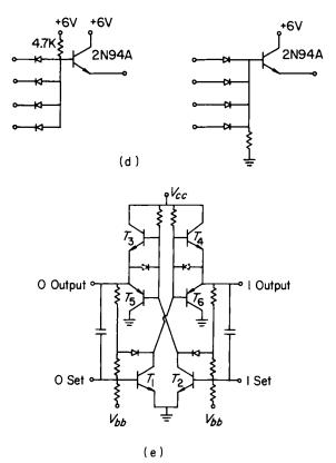
Fig. 4.38. (Continued from page 145): (d) dc gates, (e) flip-flop.
