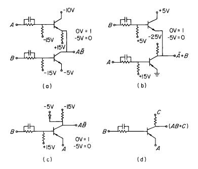
Fig. 4.26. Junction transistor gating circuits: (a)  $A\vec{B}$ , (b)  $(\vec{A} + \vec{B})$ , (c)  $A\vec{B}$ , (d) (AB + C).
