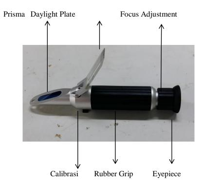
Fungsi: untuk mengukur salinitas air
