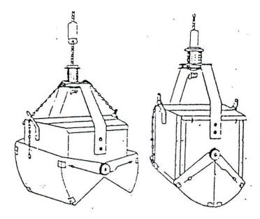
Fungsi: untuk mengambil bentos pada substrat lunak di dasar perairan
