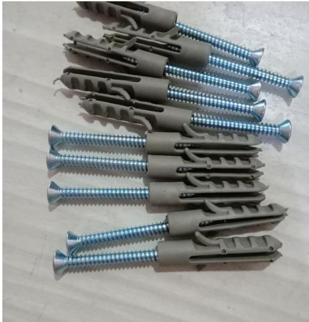
Fischer adalah pengikat antara dinding dengan benda yang digantung dengan menggunakan baut sebagai pengunci. Pada bagian ujung fischer terdapat jangkar dengan gerigi yang akan mencengkram pada bagian dalam dinding saat baut atau sekrup dimasukkan.
