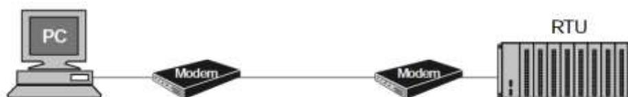
Gambar 7 : PC ke RTU menggunakan sebuah modem
